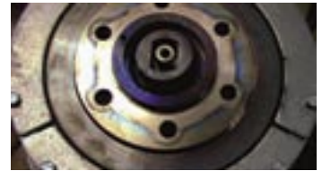
Figura 5 Rayas Oscuras del sobrecalentamiento
